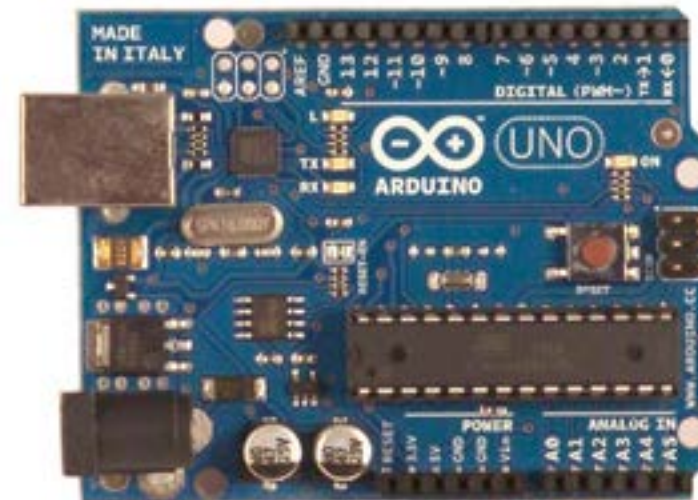
Рисунок 1 – Arduino UNO – пример Arduino-совместимой архитектуры
