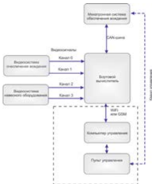
Рисунок 1 – Структурная схема робототехнического мобильного комплекса многофункционального назначения [11]
