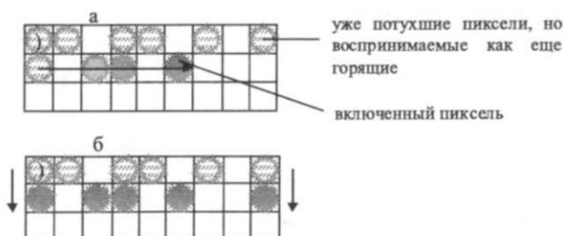
Рисунок 2 – Способы развертки: а) попиксельно; б) построчно
