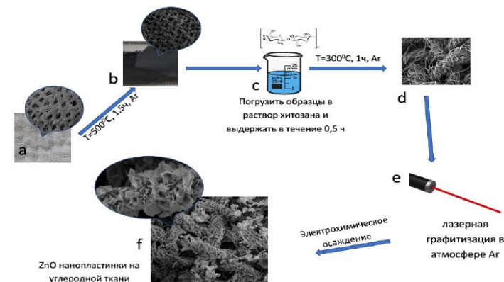
Рисунок 1 – Схема формирования нанопластин \text{ZnO} на поверхности волокон углеродной ткани
