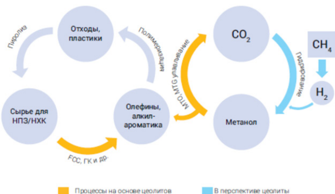
Рисунок 2 – Процессы «замкнутого цикла» и роль цеолитных катализаторов [11]
