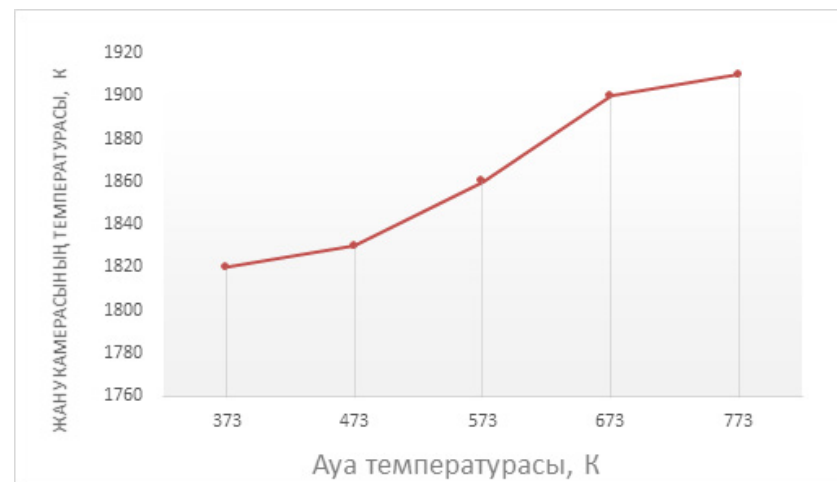
10-сурет – Ауа температурасының жану камерасынның температурасына қатынасы
