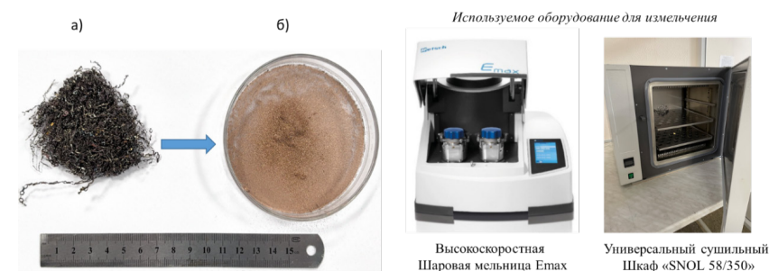
Рисунок 2 – Плата сим-карты до и после измельчения
