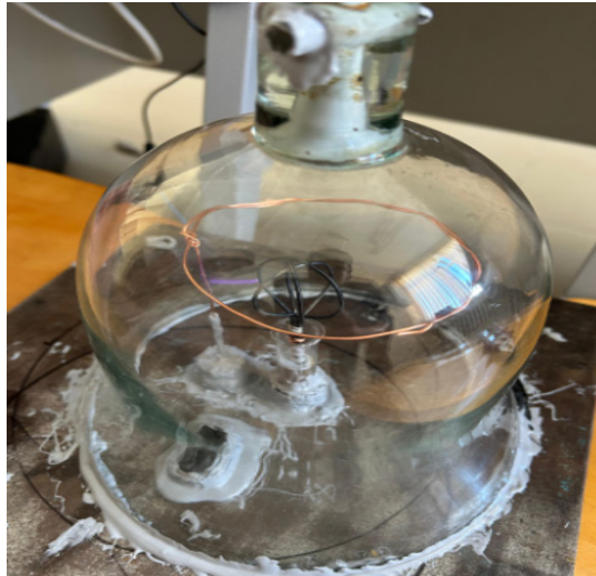
1-сурет – Вакуумда плазма алу әдісі
