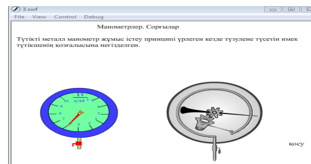
Сурет 2 – Металл манометрлердің құрылысы және қысымды өлшеу
