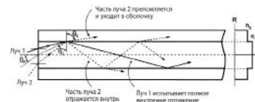
Рисунок 1 – Распространение света в волоконном световоде
