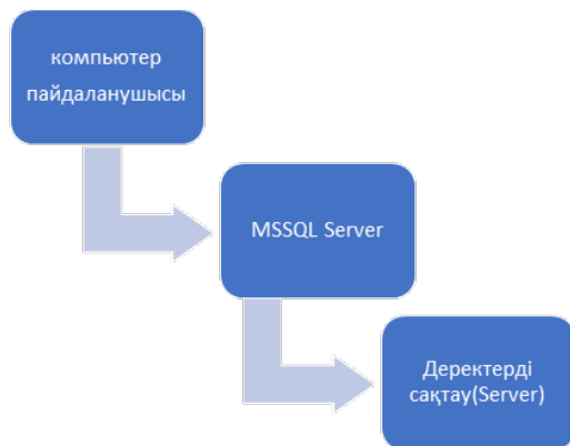
Сурет1 – Клиент/сервер «архитектурасындағы деректерді беру схемасы»
