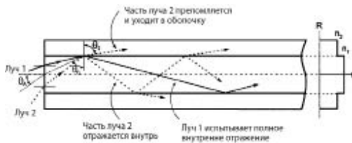
Рисунок 1 – Распространение света в волоконном световоде
